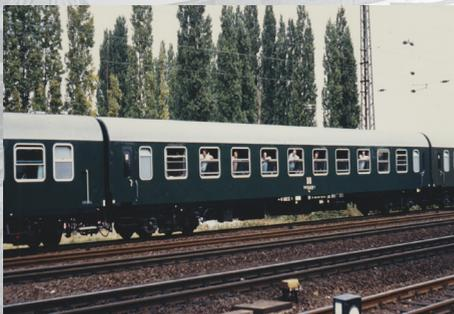
Klasse-Wagen der Gattung Ame auf Basis des Typs Z2 mit einer Länge über Puffer von 26.400 mm und flacheren Dächern als beim Typ Y. Geändert wurde die Inneneinrichtung: es wurden andere Sitzbezüge (beige-bräunlich statt grün) verwendet und die Wände und Decken mit Furnier verkleidet. Scheiben- und Übergardinen an den Fenstern vervollständigten den Look im Regierungszugstil. Die Wagen wurden ebenfalls als Gattung Ame (nicht Salon!) wie ihre „zivilen“ Pendant eingereiht und bekamen die Betriebs-
